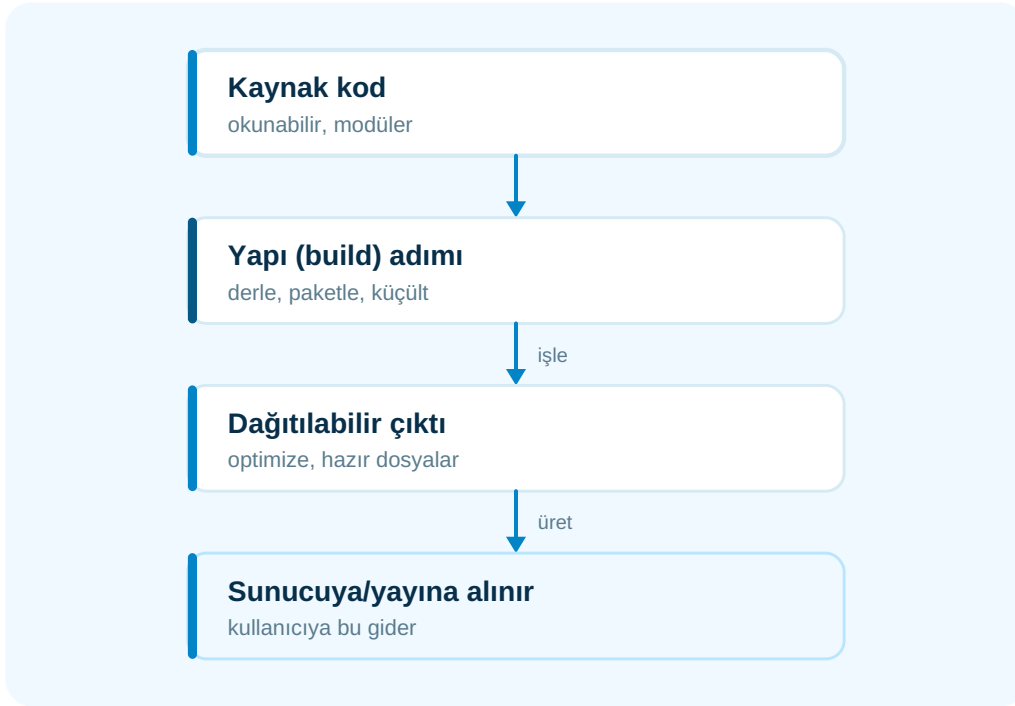
Şema 6.1 — Yapı adımı: kaynak kodu yayına uygun çıktıya dönüştürür.
