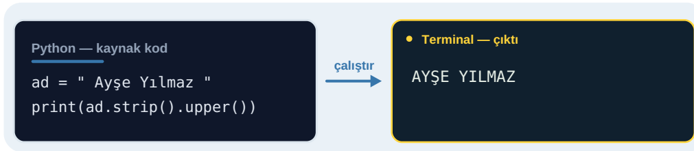
Şema 10.1 — Metin metotları zincirlenebilir: önce kırıp, sonra büyüt.
