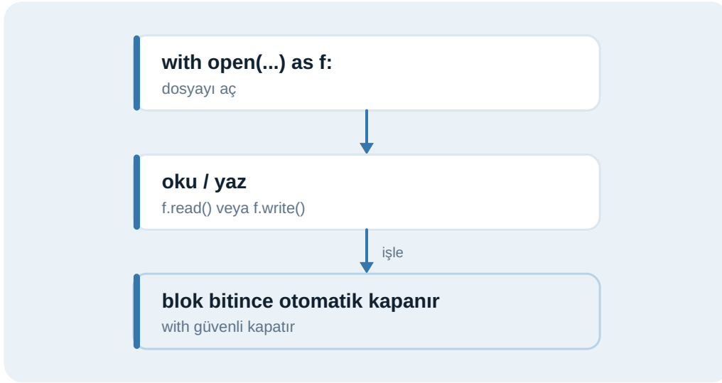
Şema 13.1 — with bloğu: dosyayı açar, işini yapar, otomatik kapatır.
