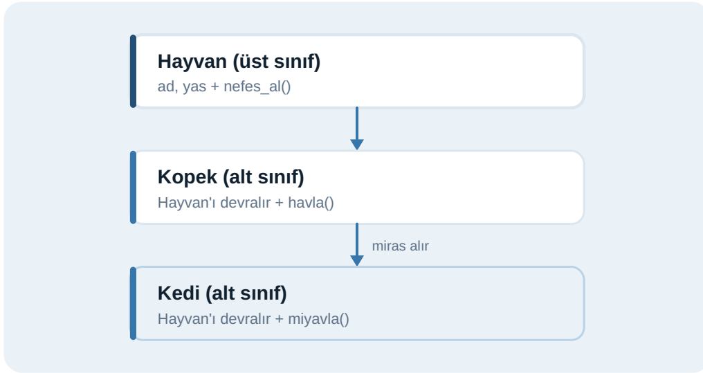
Şema 16.1 — Kalıtım: ortak özellikler üst sınıfta, özel olanlar alt sınıflarda.
