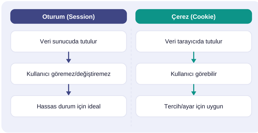
Şema 20.1 — Oturum verisi sunucuda, çerez verisi tarayıcıda saklanır.
