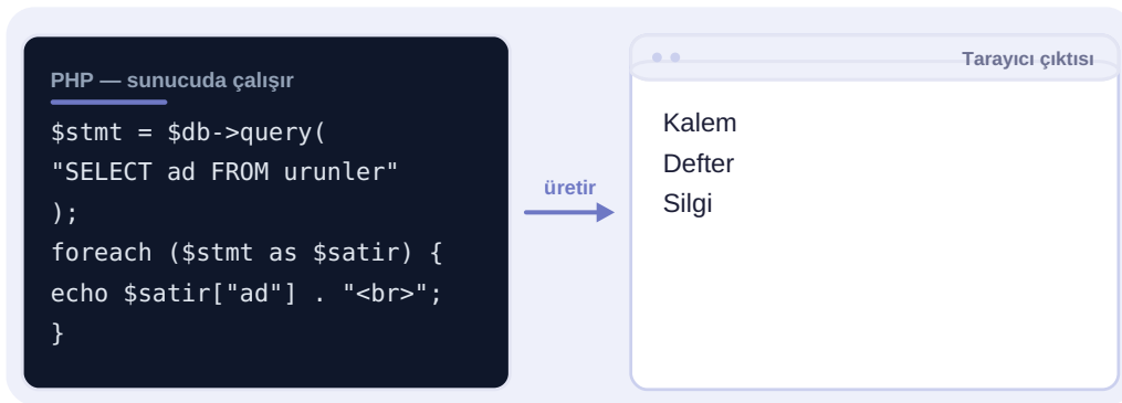
Şema 16.1 — Sorgu sonucu satırlar PHP'de dolaşılır ve yazdırılır.
