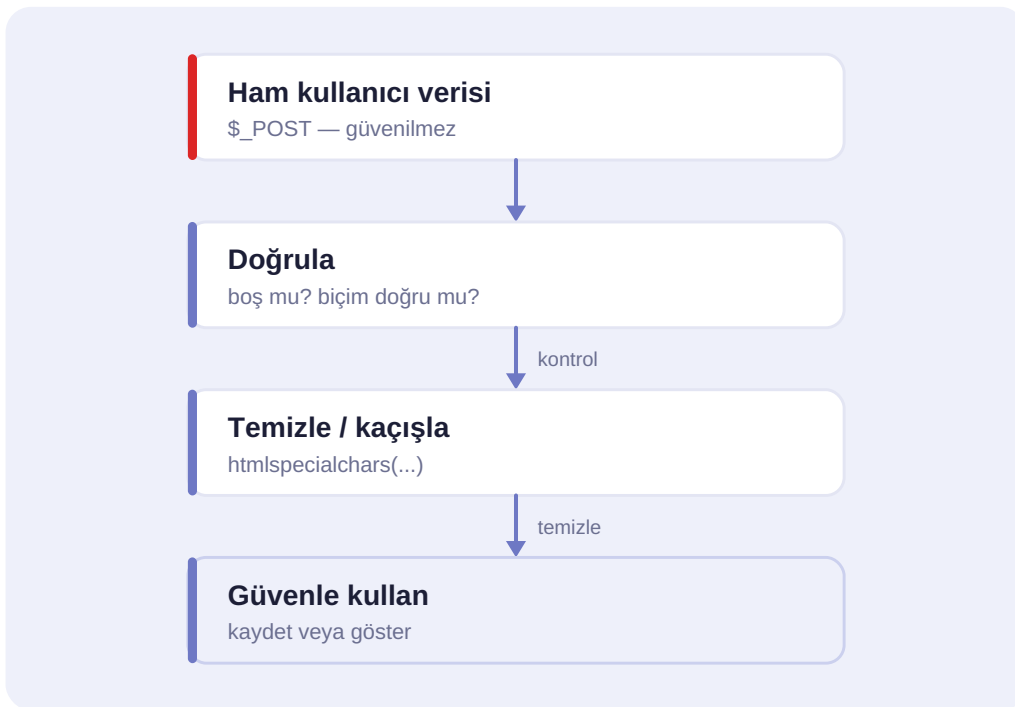
Şema 11.1 — Gelen veri önce doğrulanır ve temizlenir, sonra kullanılır.
