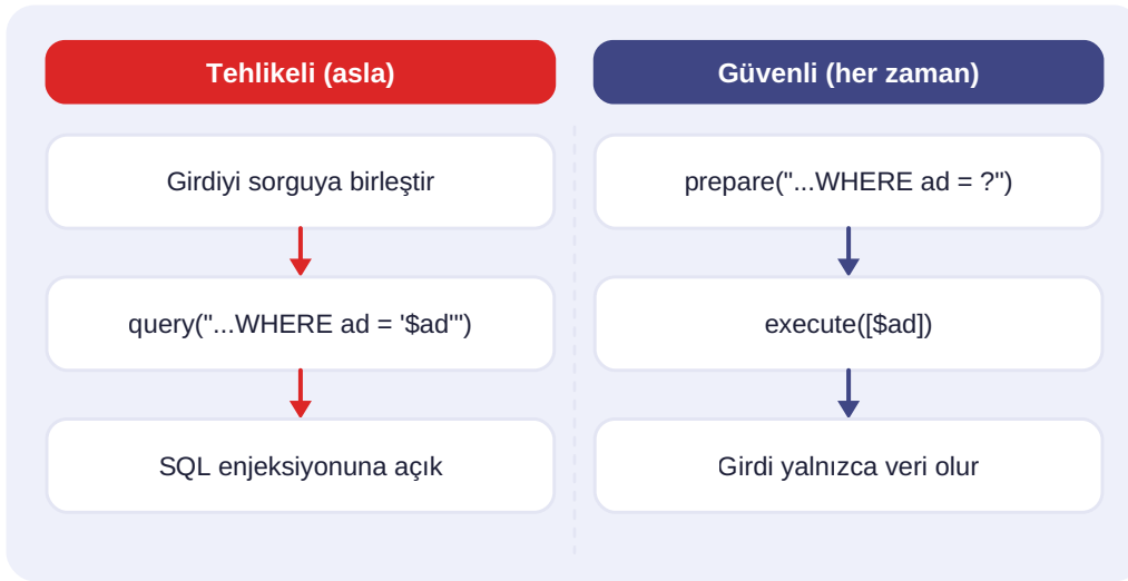
Şema 17.1 — Hazırlanmış ifade: sorgu yapısı ile kullanıcı verisini ayırır.
