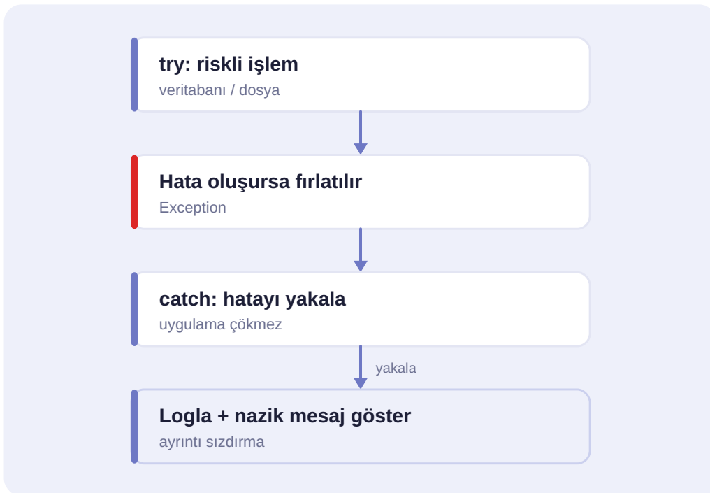
Şema 14.1 — try/catch: hatayı yakala, kullanıcıyı koru, ayrıntıyı logla.
