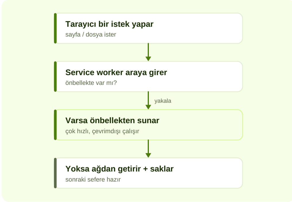
Şema 11.1 — Service worker: istekleri yakalar, önbellekten sunar, çevrimdışı çalıştırır.
