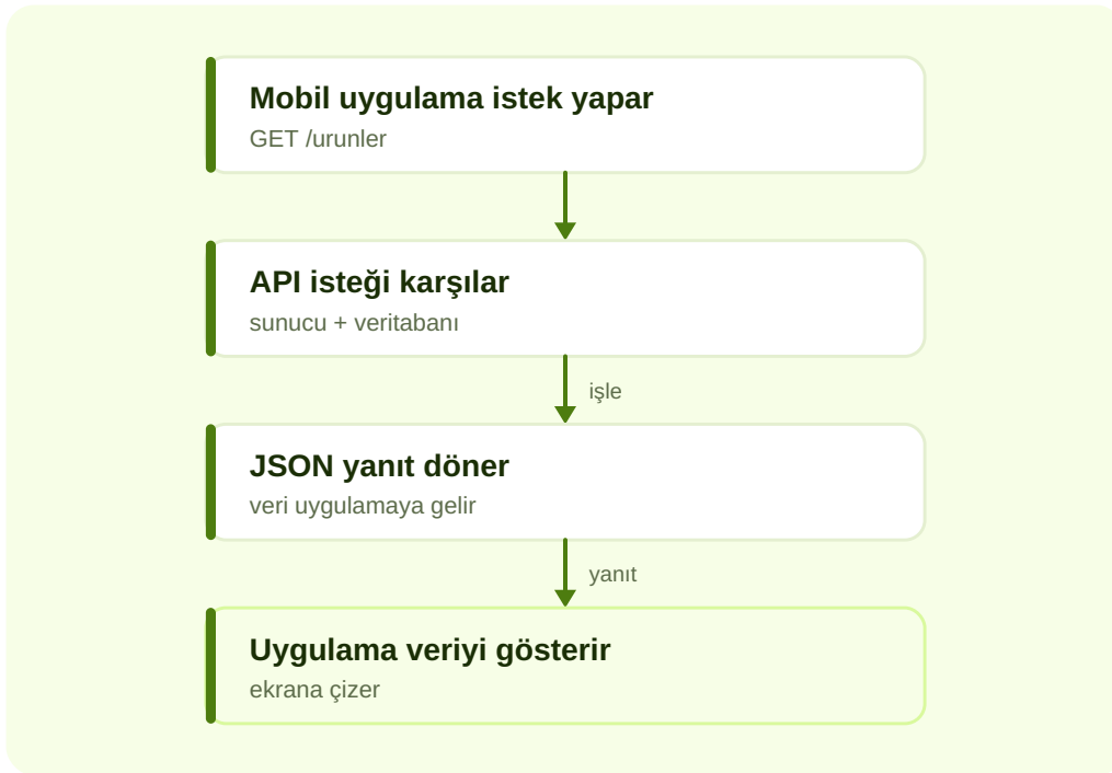
Şema 20.1 — Mobil uygulama, API üzerinden sunucudan veri alır (Modül 7).
