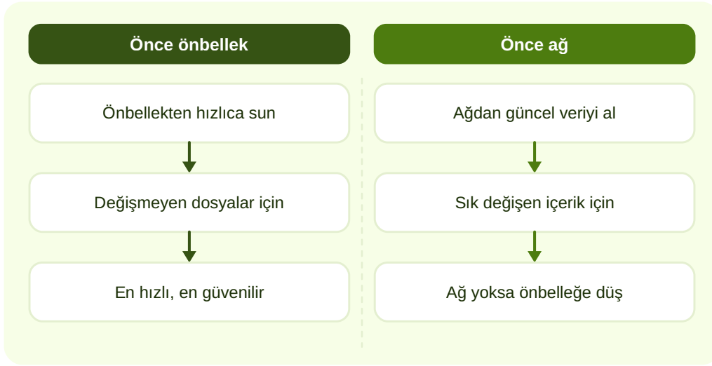
Şema 12.1 — Önbellekleme: statik için "önce önbellek", güncel için "önce ağ".
