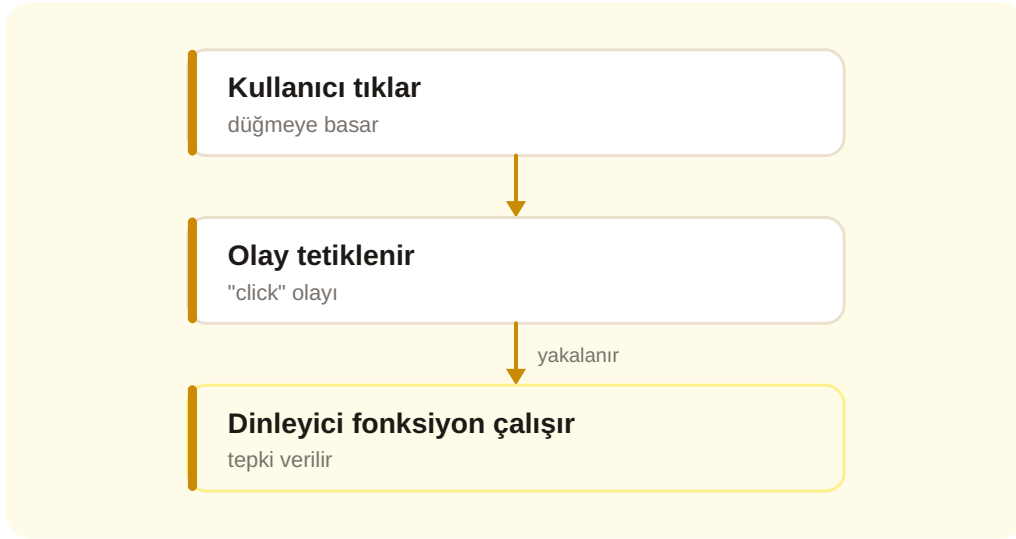
Şema 18.1 — Olay akışı: kullanıcı eylemi → olay → fonksiyon.
