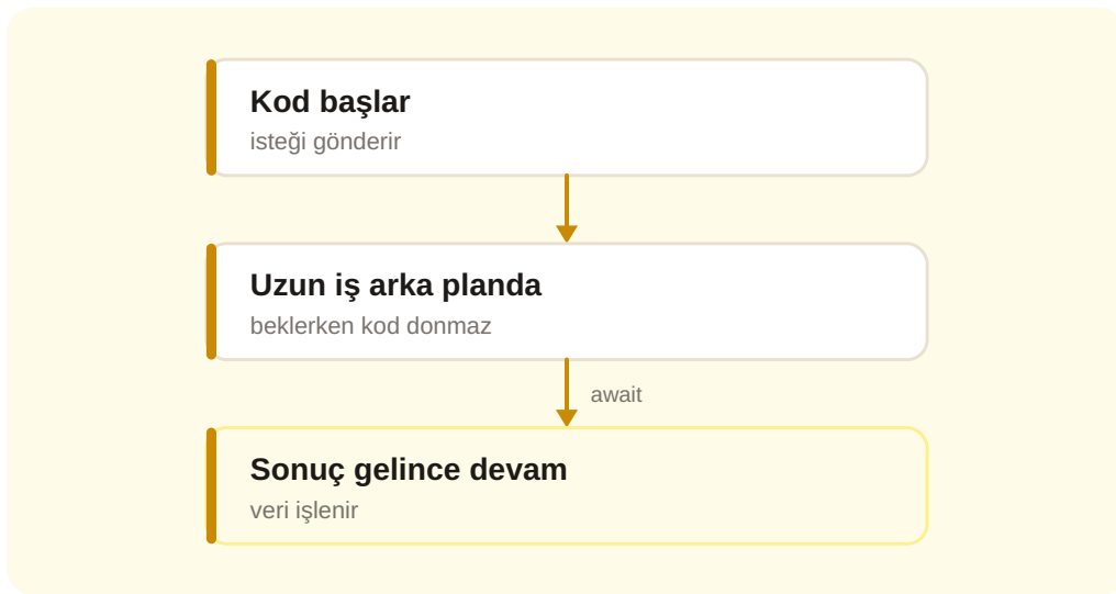
Şema 23.1 — Asenkron akış: beklerken bloklamaz, sonuç gelince devam eder.
