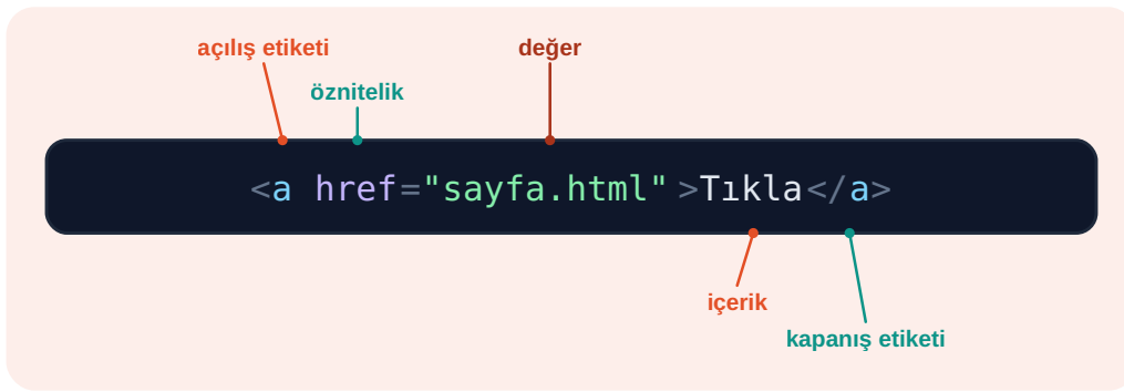
Şema 3.1 — Bir HTML elementinin parçaları: açılış etiketi, öznitelik, değer, içerik ve kapanış etiketi.
