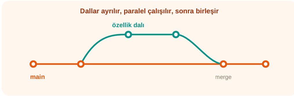
Şema 13.1 — Özellik dalı ana daldan ayrılır, geliştirilir ve sonra birleştirilir.
