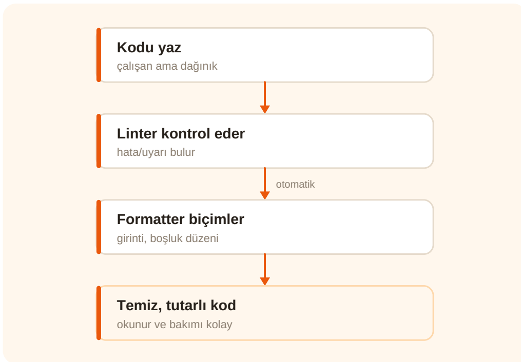
Şema 24.1 — Linter ve biçimlendirici ile kod otomatik olarak temizlenir.
