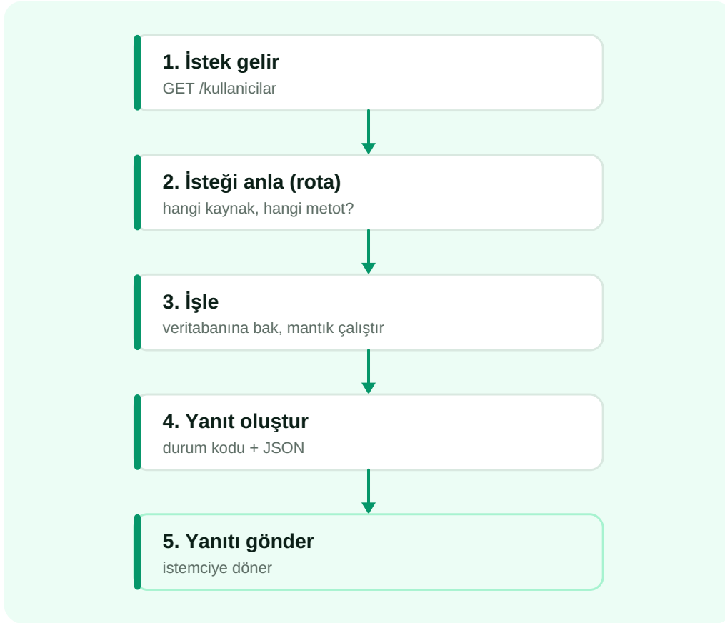
Şema 3.1 — Sunucu, her istek için bu beş adımı izler.
