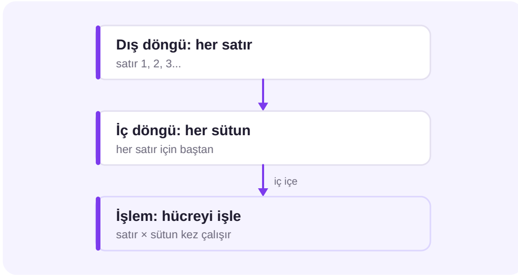
Şema 12.1 — İç içe döngü: dış döngünün her turunda iç döngü tümüyle çalışır.
